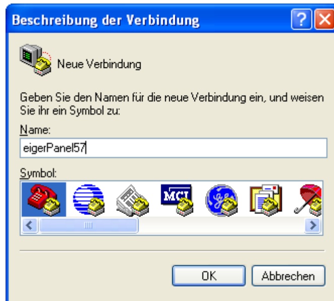
Abbildung 2: Eingangsfenster zur Installation einer neuen Verbindung über die serielle Schnittstelle.
