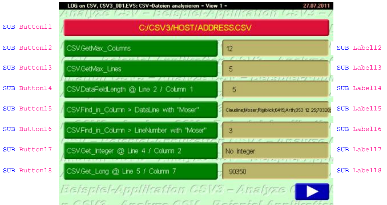
Abbildung 9: ScreenShot von View 1 aus der Beispiel-Applikation CSV3. Mit dem oberen breiten Button wird eine der beiden CSV-Dateien – LogFile.CSV oder ADDRESS.CSV – in eine Stringvariable eingelesen. In diesem Beispiel ist jedem Button eine bestimmte eigerScript-Methode aus der Klasse CSV hinterlegt, womit der eingelesene CSV-String analysiert werden kann.
