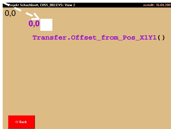
Abbildung 48: Mit Transfer.Offset_from_Pos_X1Y1() wird der Nullpunkt der View und damit alle anderen Viewkoordinaten verschoben.
