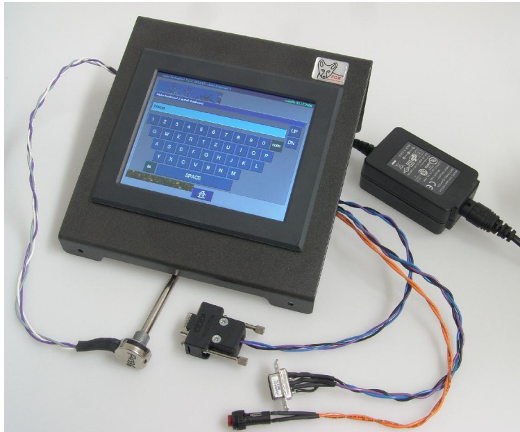
Abbildung 3: Tischgerät des eigerPanels 57 mit 5.7“ Touch-Display, Potentiometer und Anschlusskabel für COM1 und 2.
