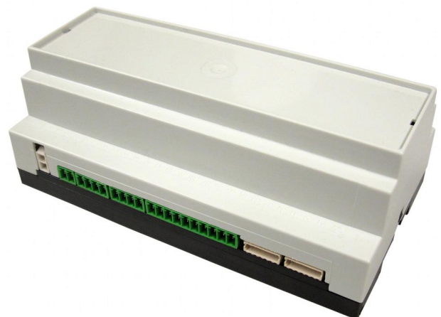
Abbildung 3: FPIO im DIN-Schienen-Gehäuse für Rastmontage auf Normschiene nach DIN EN 60 715 TH35 (Bestellnr. K2057)
