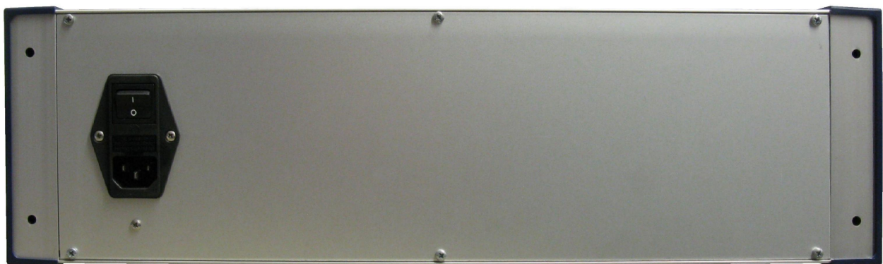
Abbildung 2: Rückseite mit 230V-Anschluss, Netzschalter und Gerätesicherung
